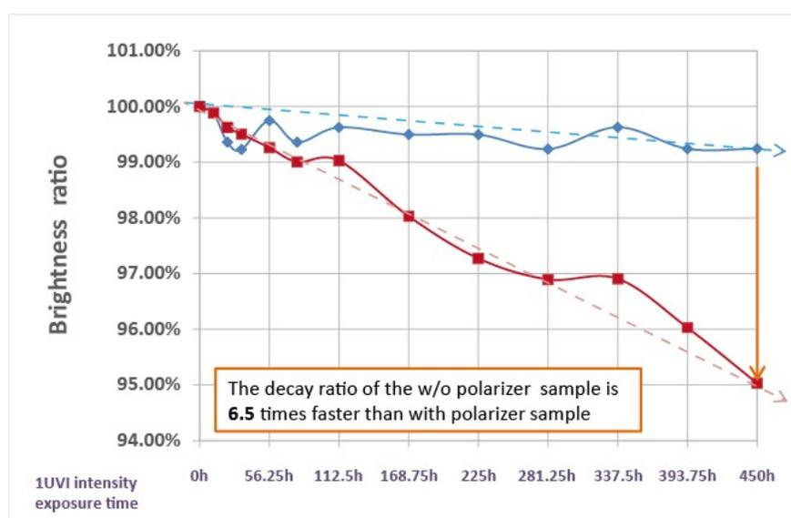
[圖3 有含(藍線)及不含(紅線)偏光片覆蓋之OLED光亮度衰減曲線]
