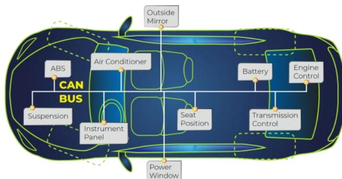
CANopen 是架構在控制器區域網路 (Controller Area Network, CAN) 上的上層通訊協定，包括通訊子協定及設備子協定常在嵌入式系統中使用。CAN 匯流排通常應用領域有: 車載、工業自動化、電梯、手扶梯、航空/航海電子儀器、建築自動化、醫療儀器及裝置...等等。華凌光電 Smart Display CanTFT 系列 標準品內建快閃記憶體(FLASH)，儲存字型及圖控物件(Object Dictionary)。
